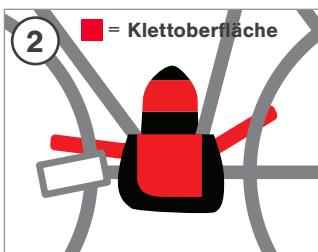
Es kann mit Hilfe der Klettbandstreifen an Ihren Rahmen und Motor angepasst werden. Das **Fibrax Motor Cover** liegt im korrekt montierten Zustand straff an Motor und Rahmen an und verursacht keine Scheuer- oder Kratzspuren, die bei Verwendung einer losen Umhüllung entstehen könnten.
