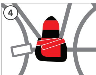
Das **Fibrax Motor Cover** verhindert nicht, dass der Motor nass wird, sondern vermeidet den direkten Anprall von Spritzwasser auf das Motorgehäuse. Die Löcher im Boden des Covers dienen dem Ablaufen von eindringender Feuchtigkeit.
